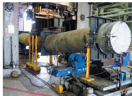
▲本体部曲げ試験(載荷後)
