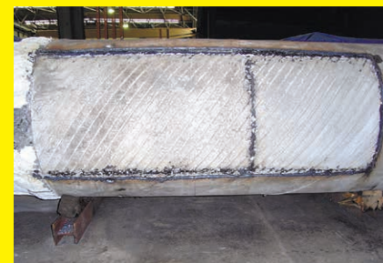
▲鋼管をカットした状況 (鋼管内部のコンクリート表面に突起の線状痕が見える)
