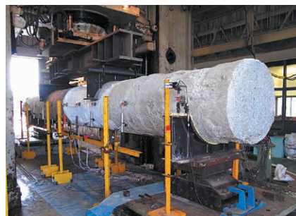
▲継手部曲げ試験
